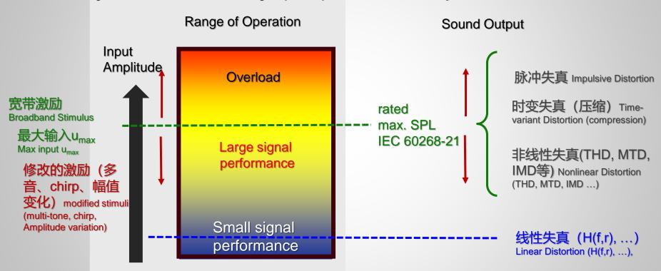
符合IEC 60268-21的额定最大SPL(最大输入电压u<sub>max</sub>)简化了基准测试!
